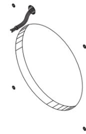
Der Lüfter wird über das Abluftrohr montiert. Stellen Sie sicher, dass das Kabel durch die mitgelieferte Kabeltülle geführt wird. Richten Sie den Ausrichtungspfeil vertikal aus. Mit den 4 mitgelieferten Schrauben befestigen Sie das Gerät an der Wand oder Decke.
