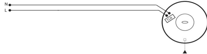
Alle elektrischen Installationen sollten von einem zugelassenen Elektroinstallateur gemäß VDE 0100 erfolgen. iCONstant-Lüfter erfordern eine 90-264V 50/60Hz-Spannungsversorgung. Diese sind schutzisoliert, so dass keine Erdung erforderlich ist und sind in Schutzzone 2 und 3 zu installieren. In Schutzzone 1 montierte Lüfter müssen über eine Schutzkleinspannungsklasse verfügen. Das iCONstant-Sortiment entspricht Schutzklasse IPX5 (strahlwassergeschützt).
